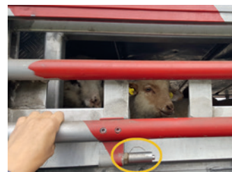
Position des abreuvoirs inadéquate, les porcs ne peuvent pas entourer l'abreuvoir avec la bouche
